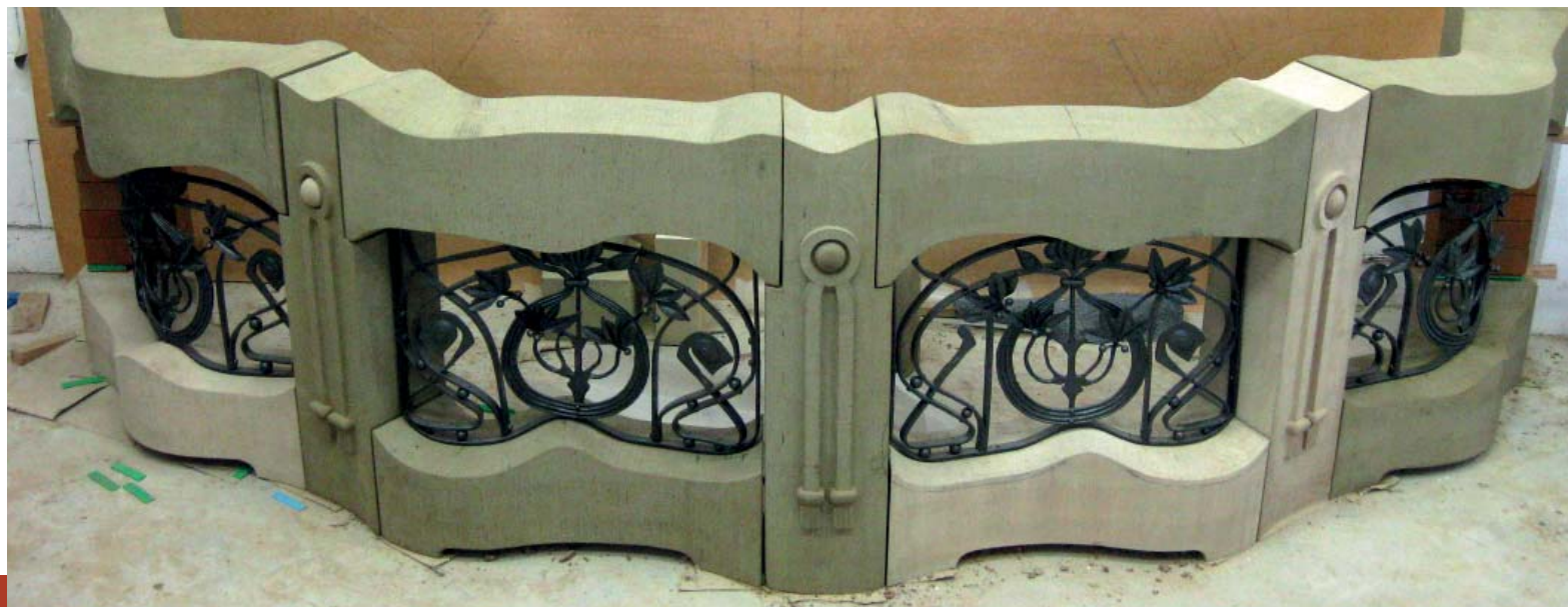
Fertige Brüstung in der Werkstatt mit Aufriss der Draufsicht im Hintergrund.
